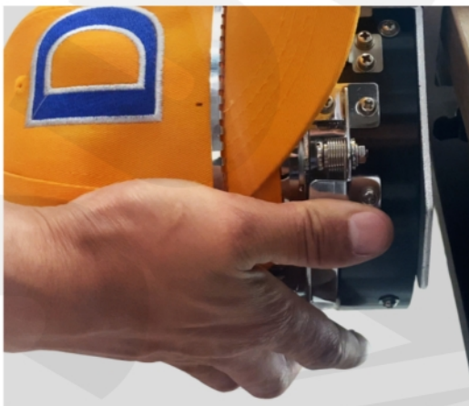
3. Insira a presilha da tira de pressão no bastidor de boné.
